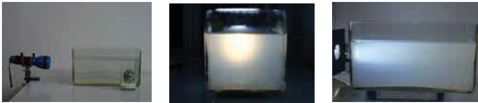
Abb. 5.89: Streuung in einem Behälter mit extrem verdünnter Milch links: der Versuchsaufbau Mitte: Blick in Richtung der Lichtquelle rechts: Blick quer zur Ausbreitungsrichtung des Lichts
